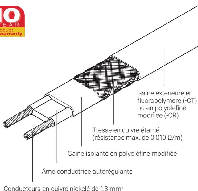
Tracage électrique pour mise hors gel (pas de nettoyage vapeur).
